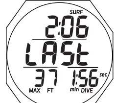
Fig. 103 - FREE SURF ALT 1 (Last Dive Data)
